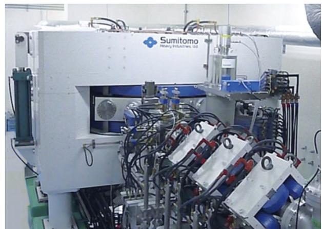
Fig. 4-2 BNCT 用サイクロトロン中性子源のサイクロトロン加速器[21]。
